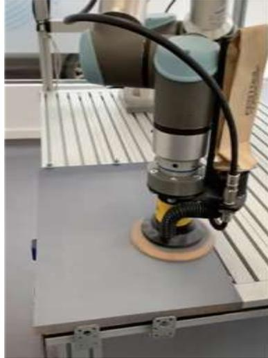
Detalle aplicación lijado robotizado.
