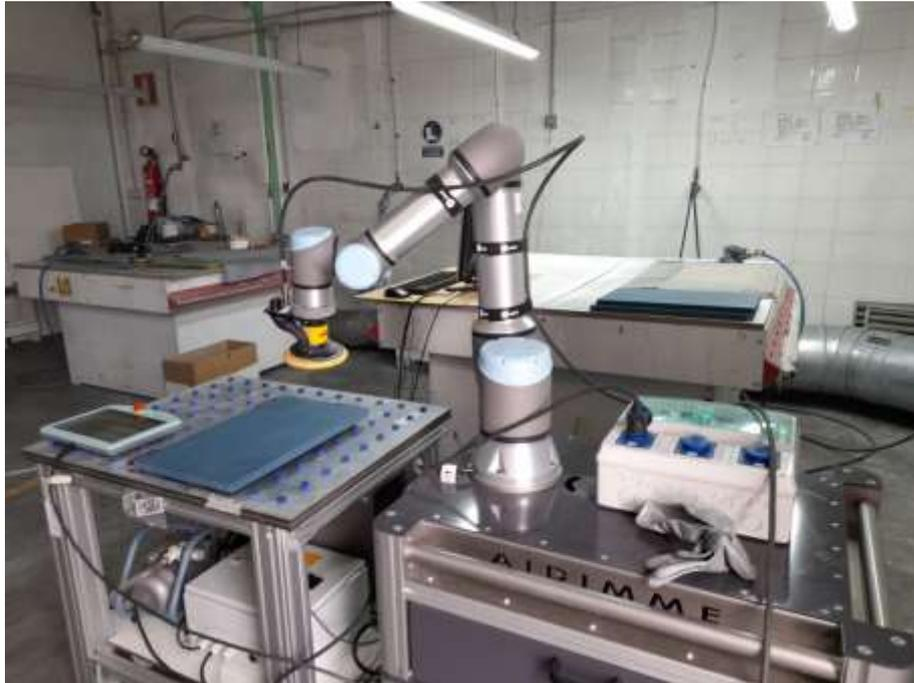
Robot listo para lijar una pieza por demostración.
