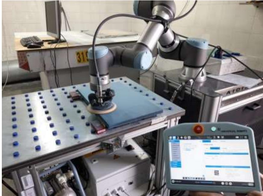
Lijado de una pieza mediante el aprendizaje por refuerzo (i).
