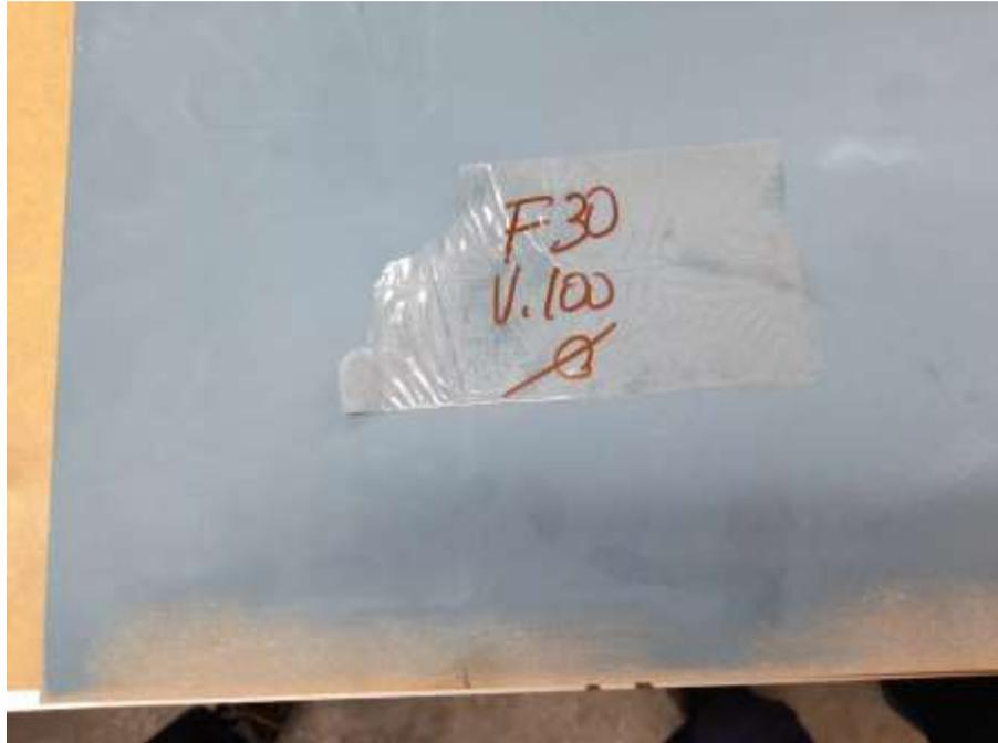
Ejemplo de pieza donde se ha producido un lijado excesivo.
