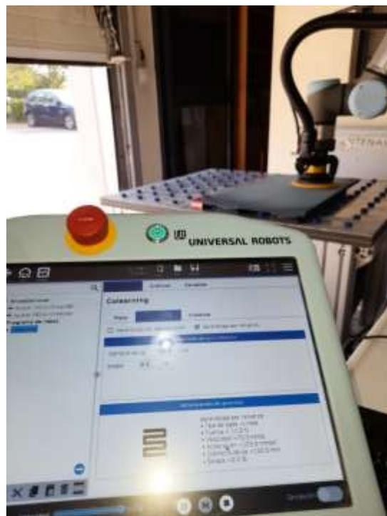
Imagen de parámetros enviados por el servidor al robot mediante la URCAP.
